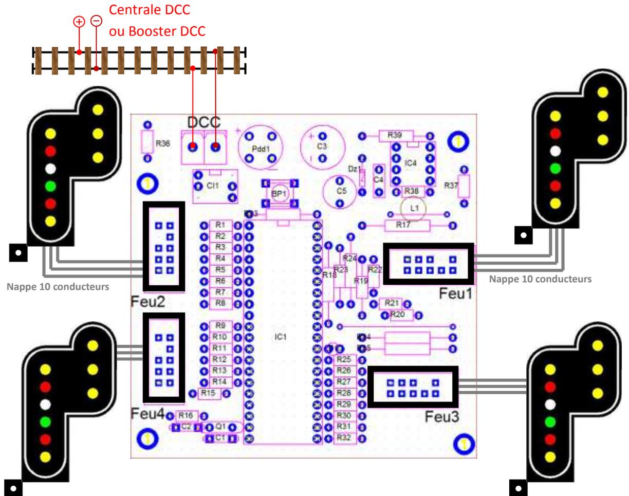
Les feux se branchent par l'intermédiaire d'un câble en nappe équipé d'un connecteur HE10 à 10 contacts. Il n'est pas nécessaire de placer de résistance sur les fils, celles-ci sont intégrées à la platine.
